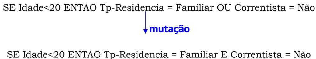
**Figura 7 Operador de Mutação de Operador**
