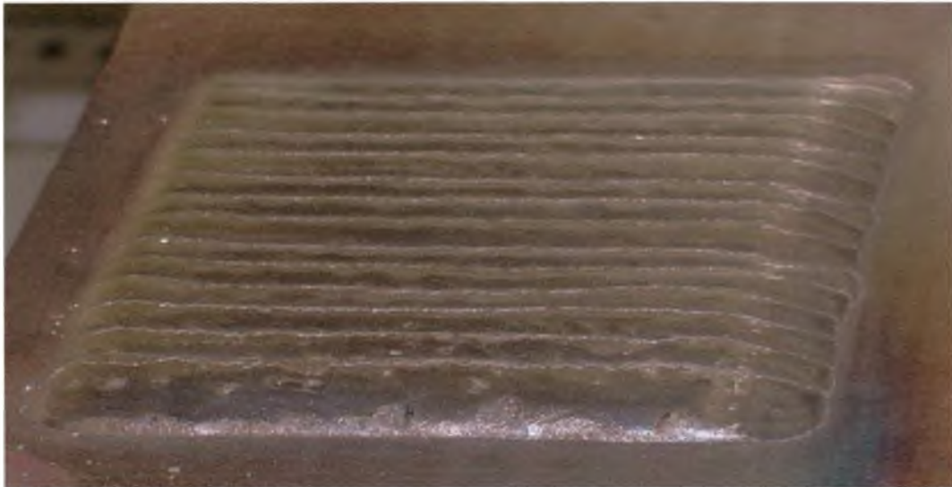
Fig. 7.24 – Depósito de Cordões Lado a Lado, Utilizando Arame AWS 309-L
