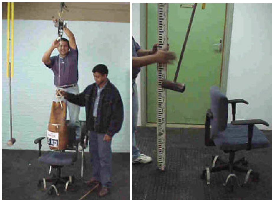
Fotos 03 e 04- Ensaios de resistência ao impacto em assento e encosto executados na CIENTEC, em cadeira de uso profissional, segundo a NBR 14110.
