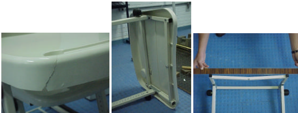
Fotos 17, 18, e 19 - Fraturas e deformações verificadas durante o ensaio de impacto no tampo
