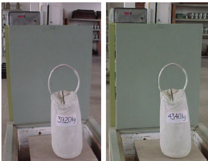
Fotos 10 e 11 - Sacos de areia carregados com os valores de cargas de ensaio
