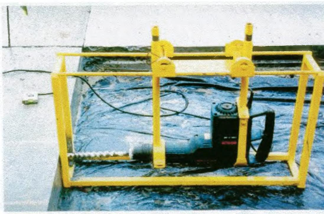
FIGURA 2.22 – Equipamento Auxiliar de Perfuração do Tipo I
