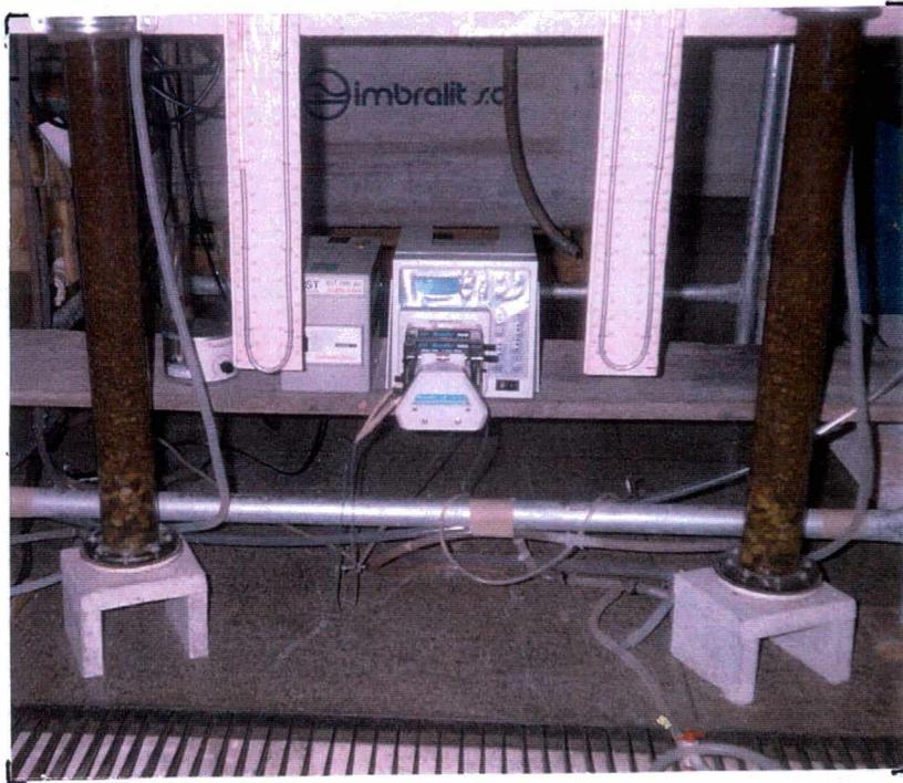
Figura 35 – Fotografia mostrando a parte inferior (camada suporte) dos filtros
