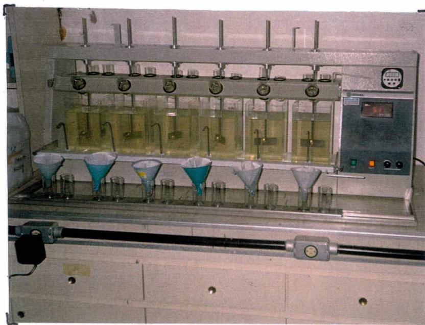
Figura 45 – Fotografia do aparelho de JAR TEST
