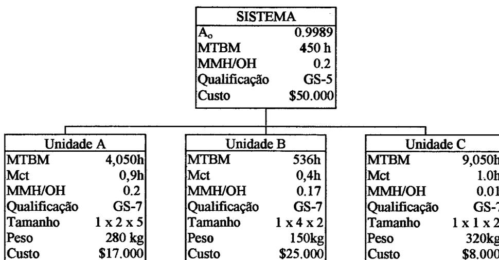
Figura 4-8: Árvore de montagem de uma alocação de requisitos (BLANCHARD & FABRICKY, 1990)
