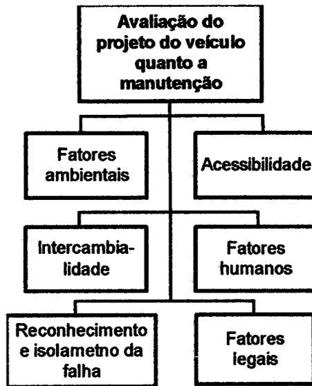
**Figura 7-8: Análise da manutenibilidade - “Estrutura lógica / avaliação do projeto do veículo quanto a manutenção” (adaptado de BLANCHARD *et al.*, 1995)**
