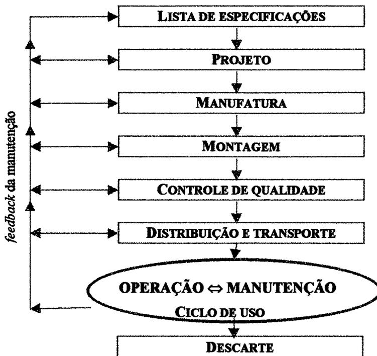
Figura 3-2: A interface da operação/manutenção com o ciclo de vida dos produtos (KELLY, 1989)
