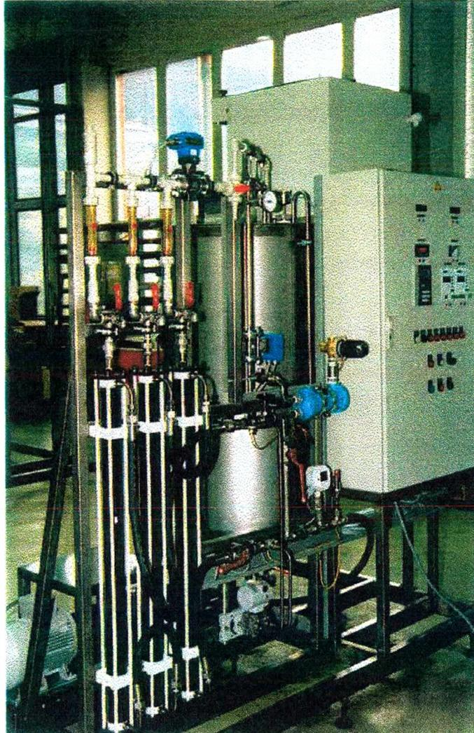
*Figura 9- Vista geral do equipamento piloto de nanofiltração “Berghof” utilizado na concentração de corantes neste trabalho.*
