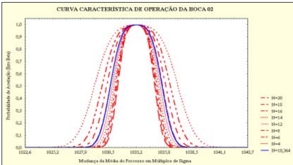
FIGURA 37: CURVA CARACTERÍSTICA DE OPERAÇÃO PARA O PESO DOS SACOS DE LEITE DA BOCA 02
