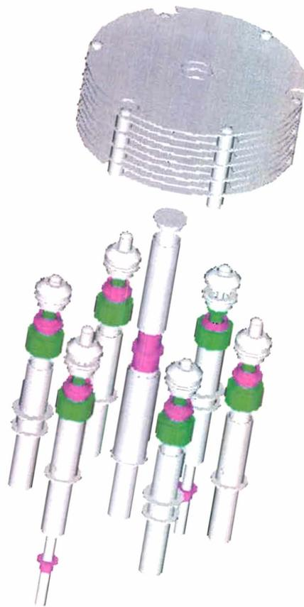
Figura 6.28: Vista explodida da montagem das colunas no interior da câmara.
