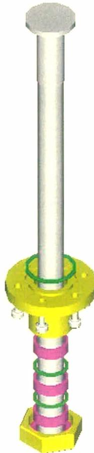
Figura 6.34: Eletrodo montado no passador - vista explodida.
