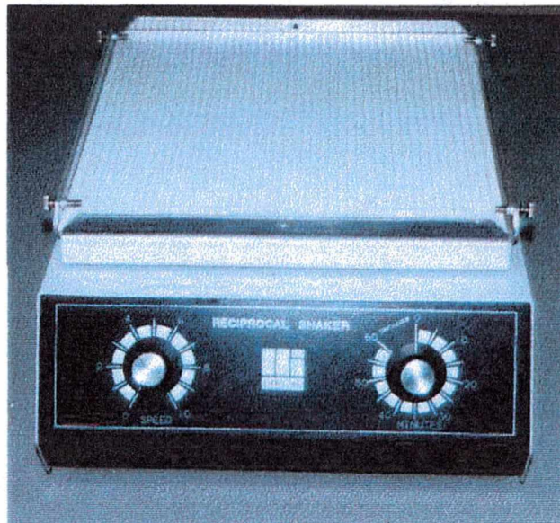
Figura 10 - Equipamento de Lixiviação - Reciprocal shaker - modelo NOS. 3506/3506-1
