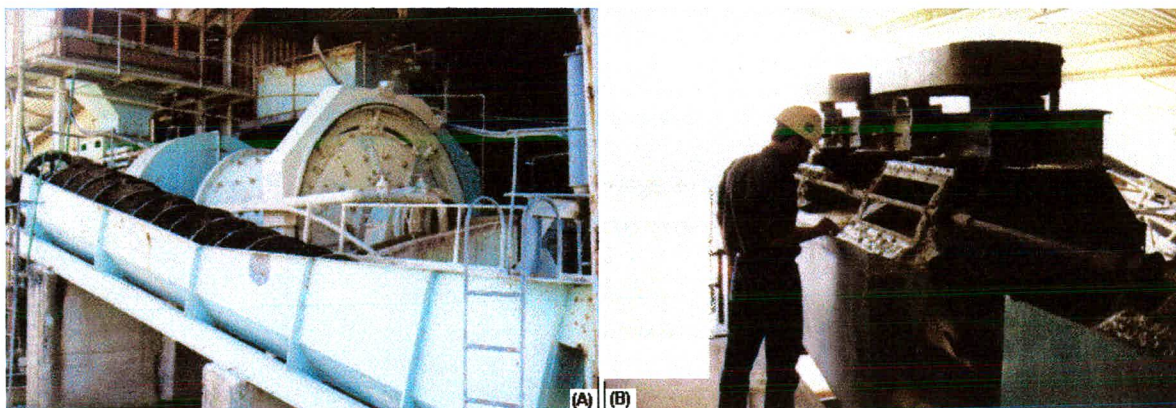
Figura 4.8 Circuito de moagem (A) e parte do circuito de flotação (B) da usina de flotação de fluorita
