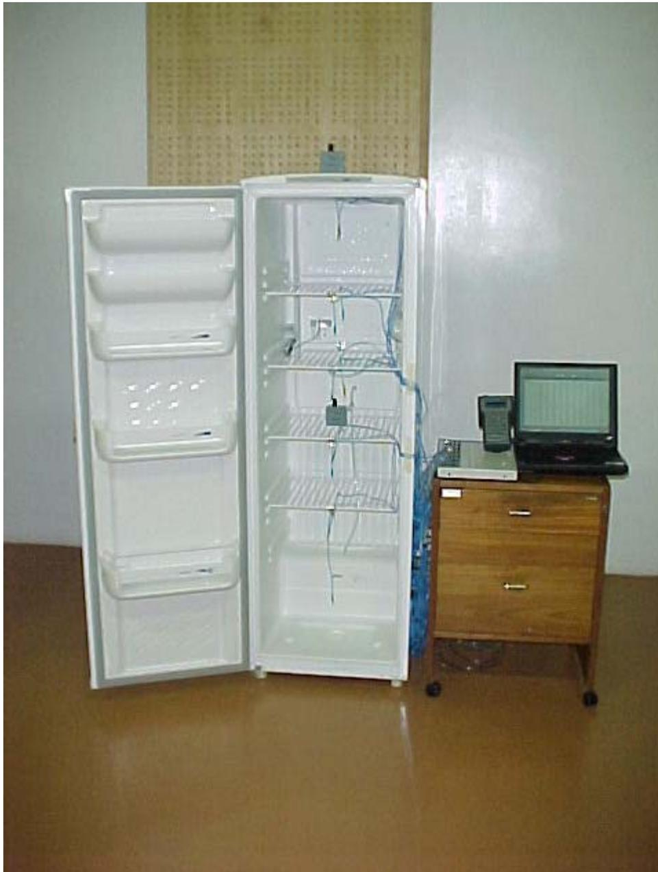
Figura 4.2 – Refrigerador e equipamento de medição
