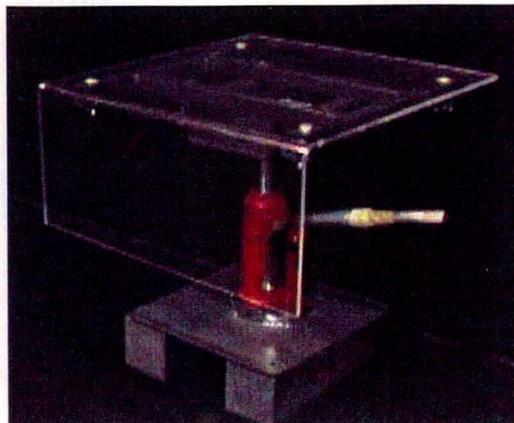
**Figura 16:** Banco antropométrico, em superfície acrílica, sustentado por macaco hidráulico, concebido para mensuração antropométrica na posição sentada.
