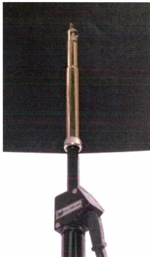
FIGURA G.6: Anemômetro de fio quente BABUC-A
