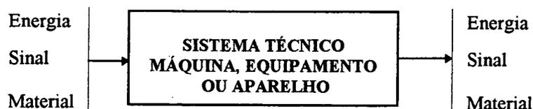
Figura 5.1 Representação abstrata de um sistema técnico. Função total. (Fonte: BACK) [1].
