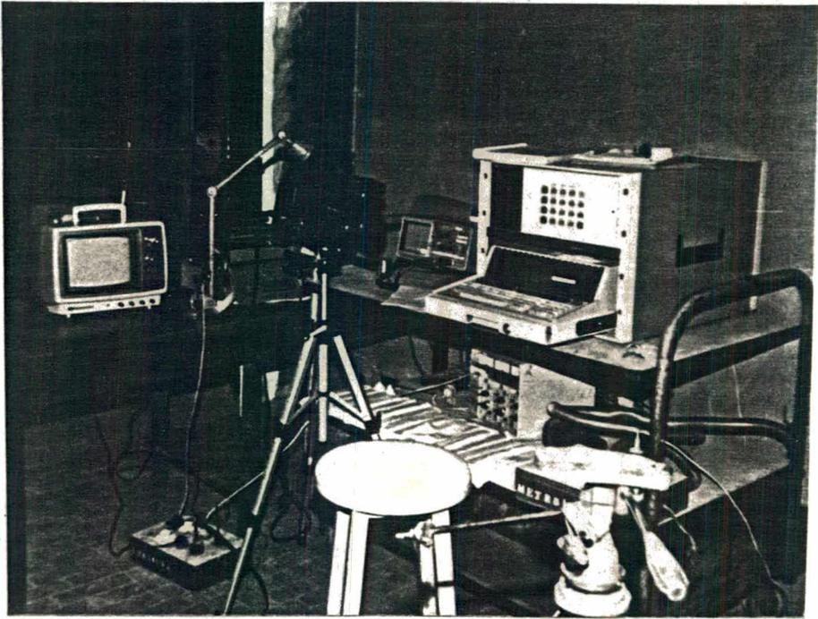
FIGURA 11 - Equipamentos utilizados para medição de corrente e tensão de soldagem em CC.
