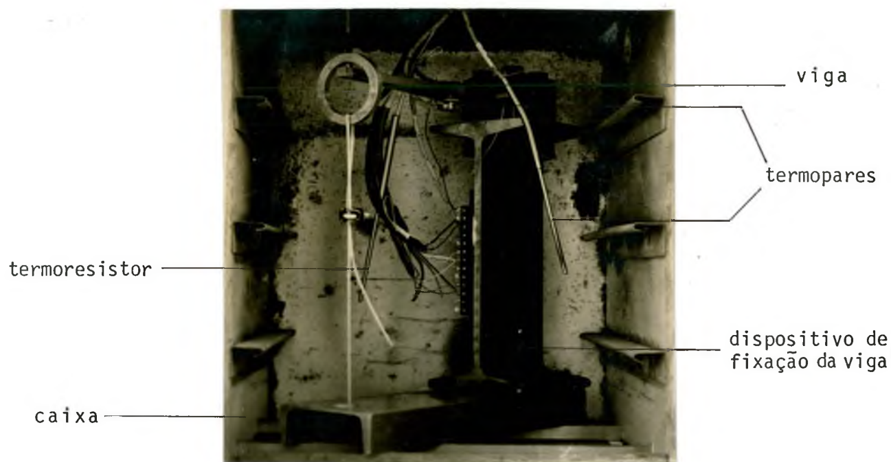
Figura 26 - Vista geral do interior da estufa 1
