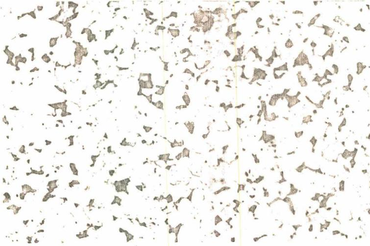
FIGURA 39 - Microestrutura do metal de base; ferrita + perlita (136X).
