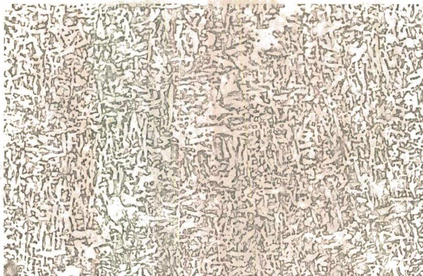
FIGURA 68 - Micrografia de região do CP-7; (A) Ferrita acicular;
