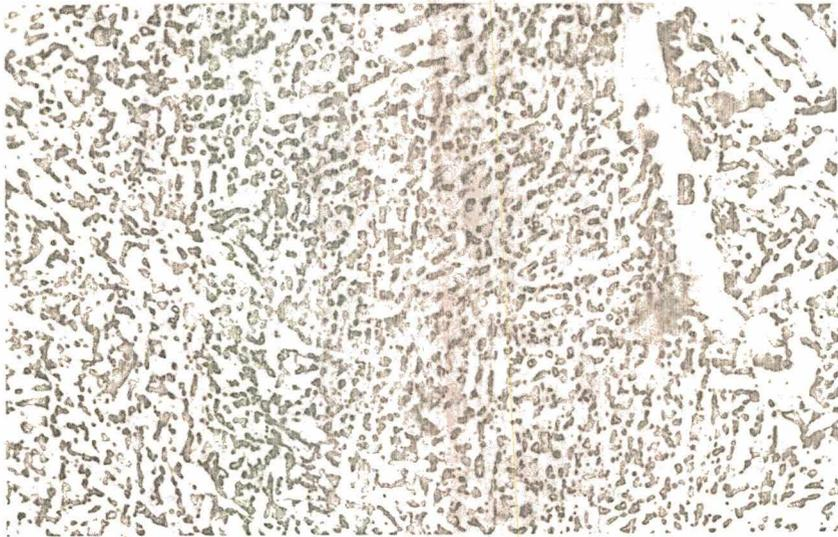
FIGURA 70 - Micrografia de região do CP-13; (E) constituinte lamelar tipo III; (B) ferrita pró-eutetóide (600 x).
