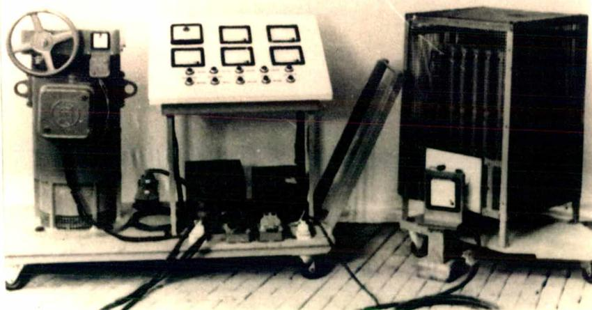
Figura 3 - Unidade de alimentação, excitação e carga do motor-gerador de c.c. - transformador variável trifásico, painel de controle, retificadores e conjunto de resistências.
