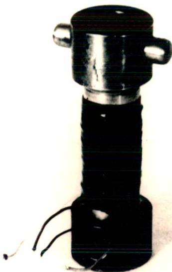
Figura 6 - Elemento elástico III - Tubo
