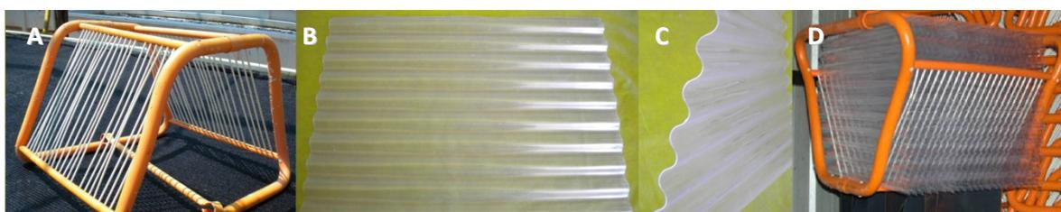
Figura 6: (a) *Holder*. (b) Placa de policarbonato. (c) Detalhe para a ondulação da placa. (d) *Holder* com placas
