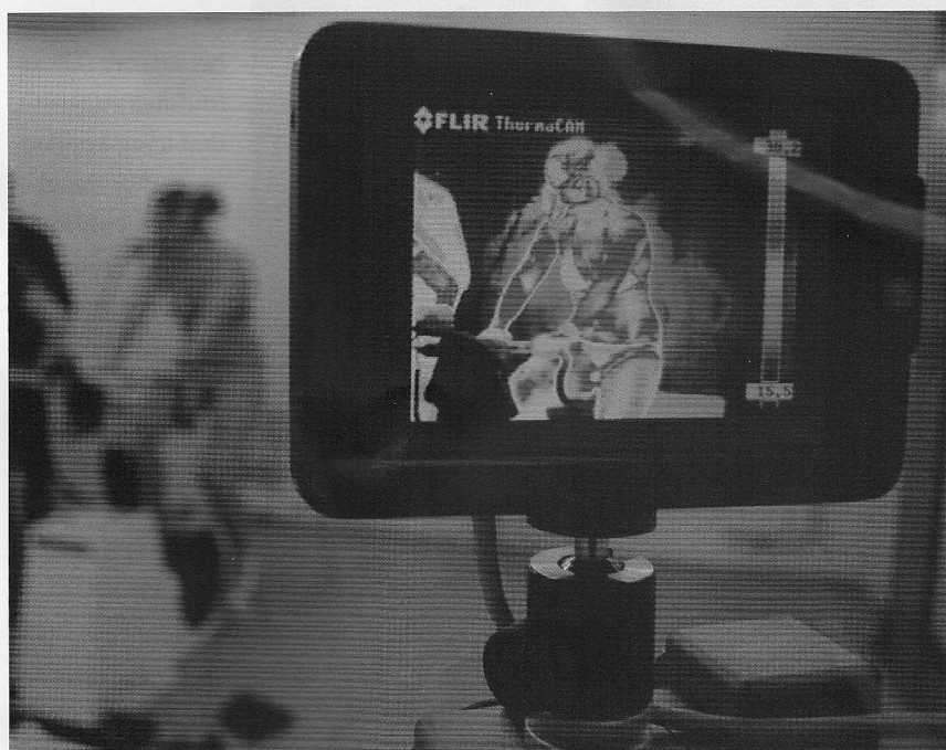
De warmtebeeldcamera toont de warmte-afgifte door de huid tijdens inspanning in de warmte.
