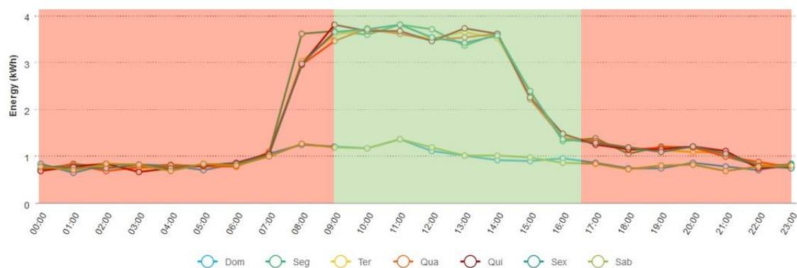
Figura 74 [Q.E.C.T.(N)] Relação entre a evolução comparativa do consumo elétrico médio horário do 01 de maio de 2013 a 01 de maio de 2014 e o período de funcionamento.
