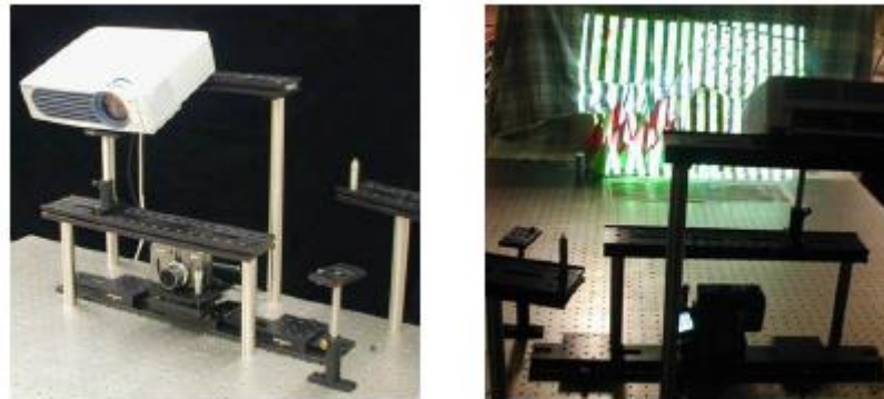
Figura 4.28 - Esquerda: Configuração da câmera e do projetor em relação ao objeto; Direita: Projeção dos padrões de luz estruturada [67].
