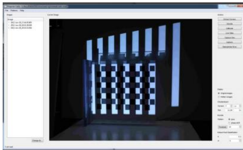
Figura 2.6 - Software de calibração de luz estruturada desenvolvido pela Brown University School of Engineering [70].
