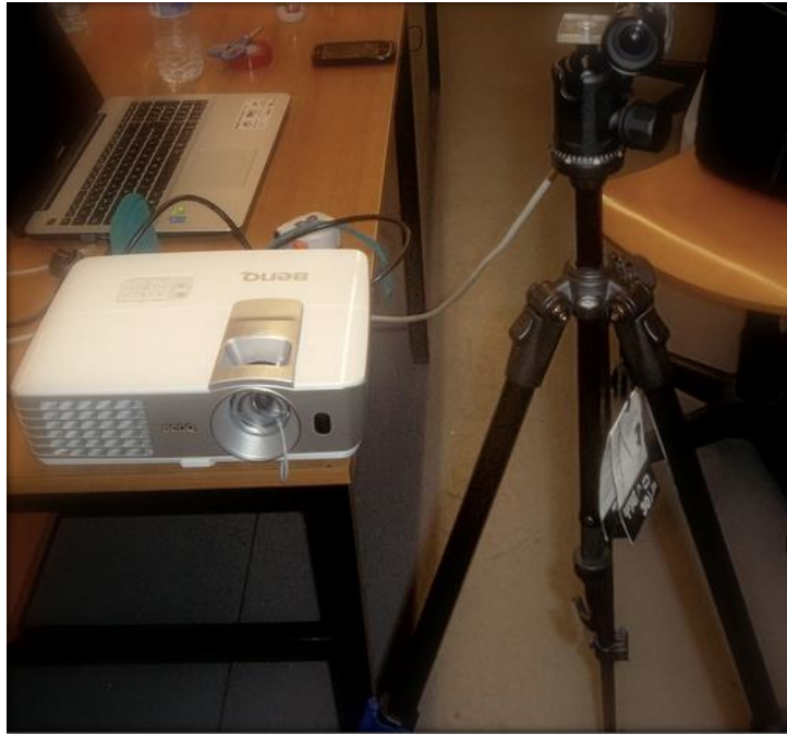
Figura 4.1 - Setup câmara-projetor visto de uma perspetiva dianteira.
