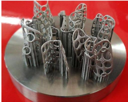
Figura 19: Disco de fabricação com os implantes e os respetivos suportes
