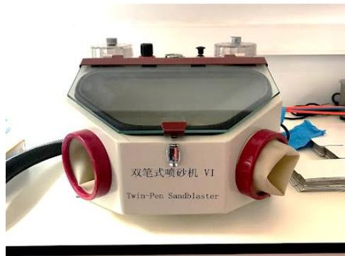
Figura 13: Equipamento utilizado para jateamento
