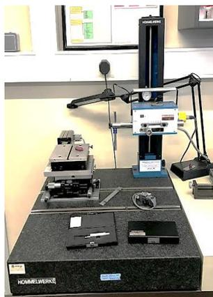
Figura 15: Perfilômetro mecânico HommelWerke T8000, INEGI
