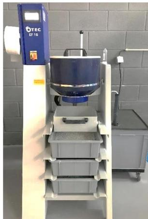
Figura 12: Equipamento utilizado para polimento
