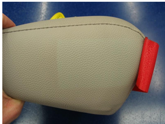
Figura 6 Encosto de cabeça exposto onde se deu a descoloração (extraído de [5])
