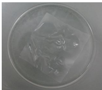
Figura 68 Teste 2: PUR C (Cor: Não houve alterações)
