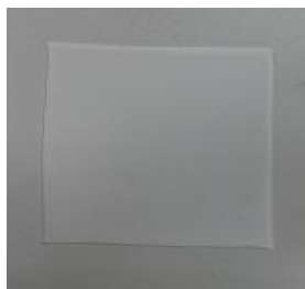
Figura 58 Filme do PUR A (PUR em meio aquoso; incorporado nas lacas do direito 2 e 3)
