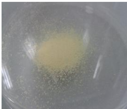
Figura 39 Teste 1: Antioxidante Cyanox 1790 com 12 mL de NO, ao fim de 16 horas (Cor: Amarelo)
