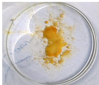
Figura 36 Teste 3: Antioxidante Irganox 1010 com 12 mL de NO e 0,15 g de DABCO 33-LV, depois de 6 horas ao sol (Cor: Amarelo forte)
