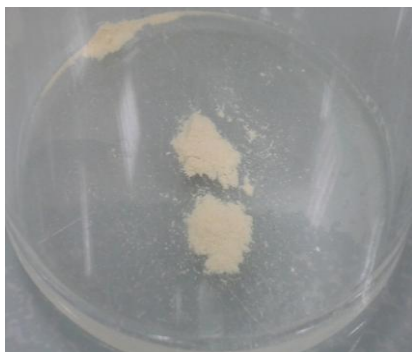
Figura 33 Teste 2: Antioxidante Irganox 1010 com 18 mL de NO, ao fim de 16 horas (Cor: Amarelo)
