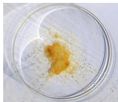
Figura 38 Teste 4: Antioxidante Irganox 1010 com 18 mL de NO e 0,15 g de DABCO 33-LV, depois de 6 horas ao sol (Cor: Amarelo forte)
