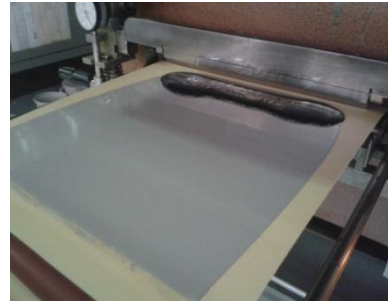
Figura 18 Aplicação da pasta de espuma sobre a segunda camada de PVC
