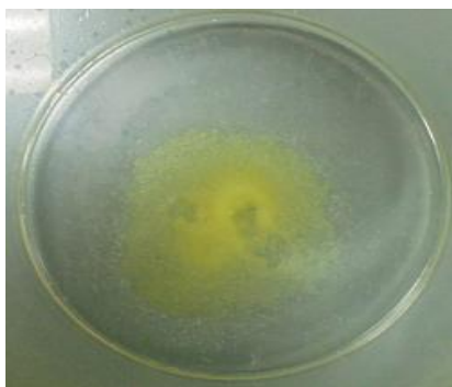
Figura 49 Teste 4: Antioxidante Irganox 1330 com 18 mL de NO e 0,15 g de DABCO 33-LV, ao fim de 16 horas (Cor: Amarelo)
