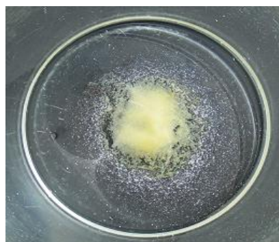
Figura 48 Teste 3: Antioxidante Irganox 1330 com 12 mL de NO e 0,15 g de DABCO 33-LV, depois de 6 horas ao sol (Cor: Amarelo pálido)
