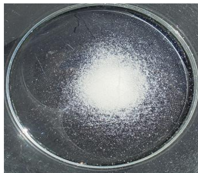
Figura 44 Teste 1: Antioxidante Irganox 1330 com 12 mL de NO, depois de 6 horas ao sol (Cor: Branco)
