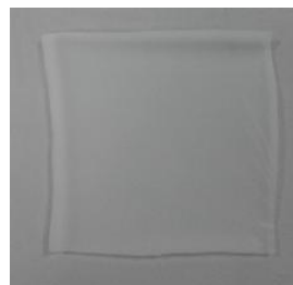
Figura 59 Filme do PUR B (PUR em meio solvente; incorporado na laca do avesso)
