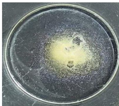
Figura 50 Teste 4: Antioxidante Irganox 1330 com 18 mL de NO e 0,15 g de DABCO 33-LV, depois de 6 horas ao sol (Cor: Amarelo pálido)
