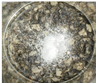
Figura 32 Teste 1: Antioxidante Irganox 1010 com 12 mL de NO, depois de 6 horas ao sol (Cor: Branco)
