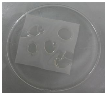
Figura 66 Teste 2: PUR A (Cor: Não houve alterações)
