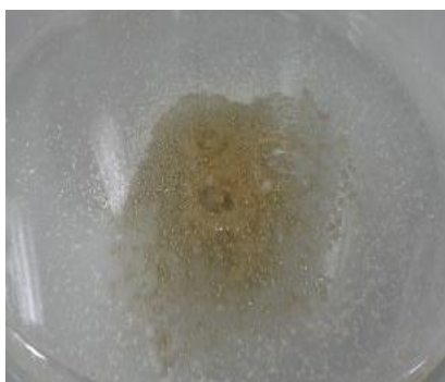
Figura 41 Teste 3: Antioxidante Cyanox 1790 com 12 mL de NO e 0,15 g de DABCO 33-LV, ao fim de 16 horas (Cor: Acastanhado)
