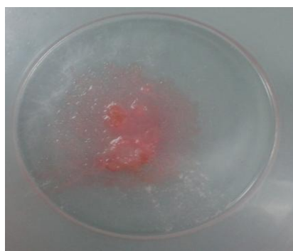
Figura 37 Teste 4: Antioxidante Irganox 1010 com 18 mL de NO e 0,15 g de DABCO 33-LV, ao fim de 16 horas (Cor: Vermelho)
