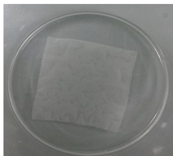
Figura 63 Teste 1: PUR B (Cor: Não houve alterações)
