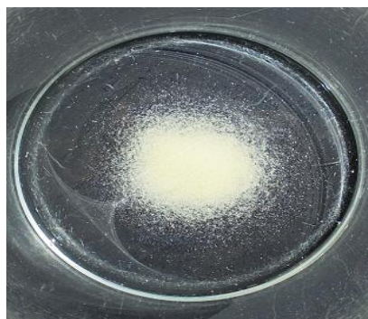
Figura 46 Teste 2: Antioxidante Irganox 1330 com 18 mL de NO, depois de 6 horas ao sol (Cor: Branco)
