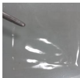
Figura 61 Filme do PUR D (PUR em meio solvente; incorporado na laca do avesso)
