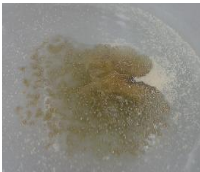
Figura 42 Teste 4: Antioxidante Cyanox 1790 com 18 mL de NO e 0,15 g de DABCO 33-LV, ao fim de 16 horas (Cor: Acastanhado)
