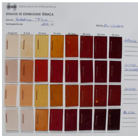
Figura 70 Relatório de Formação no Grupo PVC - Fotografia do ensaio de estabilidade térmica (210 °C; 35 minutos)
