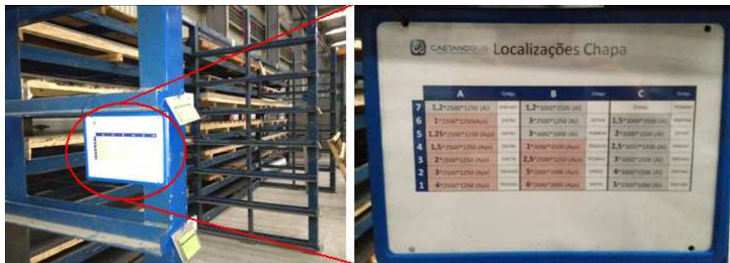
Figura 19 - Quadro de disposição das chapas
