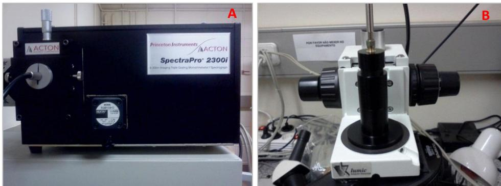
**Figura 13** – Fibra ótica que conecta o espectrógrafo ao microscópio de CL. A- Conexão da fibra ótica ao espectrógrafo; B- Conexão da fibra ótica ocular do microscópio.
