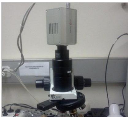
**Figura 12** – Câmara KAPPA DX 40C acoplada ao microscópio.
