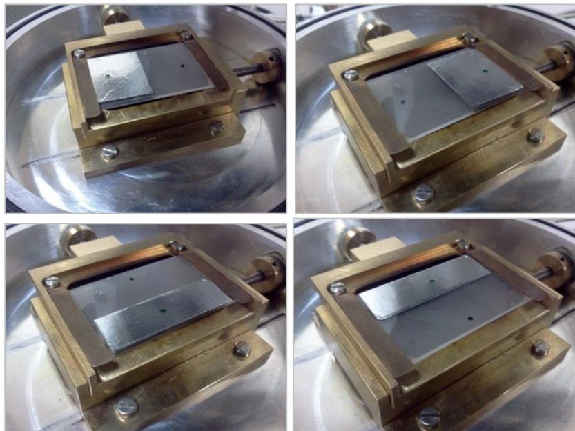
**Figura 50** – Posições das lâminas parcialmente cobertas com alumínio utilizadas.
