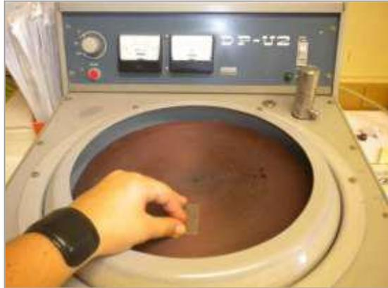
Figura 60 – Disco giratório utilizado para o polimento das amostras com abrasivos.
