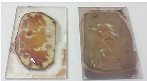
**Figura 63** – Amostras danificadas após terem sido expostas a diversos ciclos de aquecimento.
