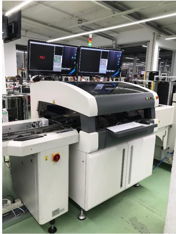
Figura 20: Linha de produção – Equipamento de inspeção de montagem
