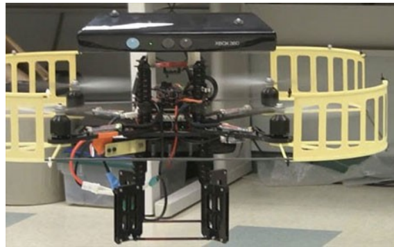
Figura 2.10: Robot equipado com o Kinect [44]
