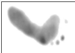
Figura 15 - Imagem (negada) após remoção do ruído e aplicação de um filtro Gaussiano.
