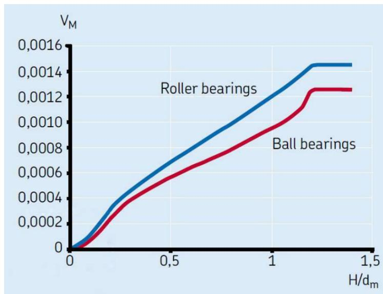
Figure 5.11.: Drag loss factor graph [36].
