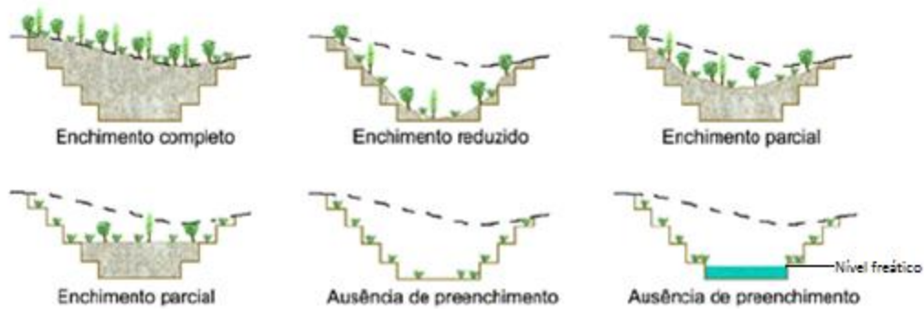
Figura 5 - Tipos de preenchimento possíveis para vazios resultantes da exploração de pedreiras. Adaptado de: (Correia & Sousa 2012)
