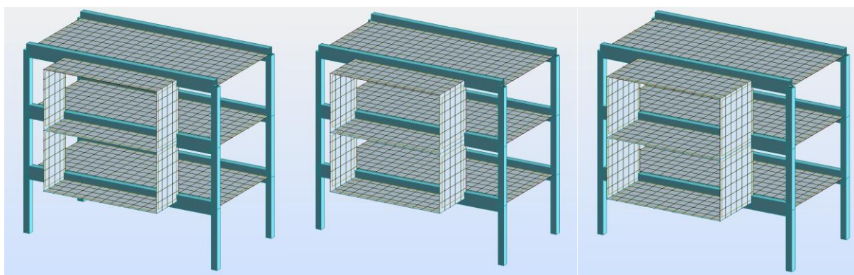
Fig. 6.3 – Colocação de paredes de betão armado nos bordos das zonas de lajes em consola para o caso B
