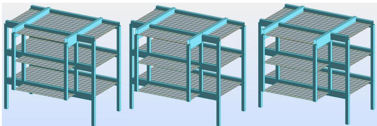
Fig. 6.16 – Colocação de viga rígida na parte superior edifício com tirantes para o caso B
