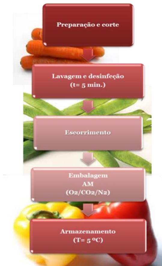
Figura 2 - Fluxograma do processamento mínimo de legumes
