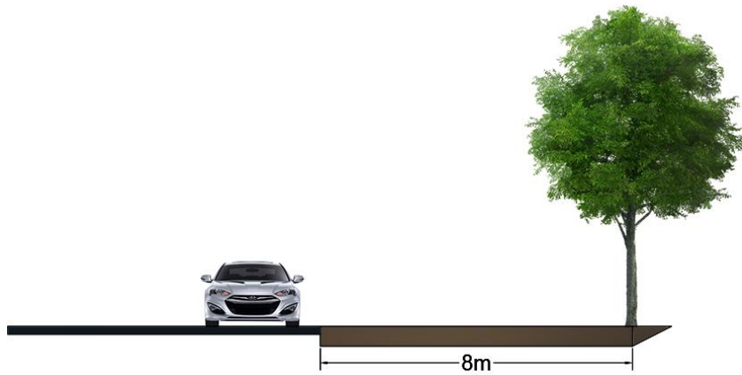
Figura 7- Zona livre para estradas rurais com limite de velocidade 90 Km/h;
