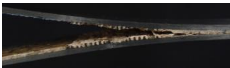
Figura 11 - Detalhe que mostra a dificuldade em identificar a frente de fenda num ensaio DCB (Fernandes et al. 2014)
