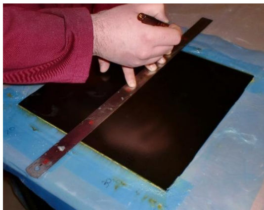
Figura 25 - Marcação dos contornos dos cortes
