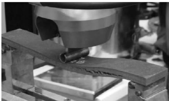
Figura 6 - Propagação de uma fenda numa estrutura sanduíche com peles de C-E e núcleo de aglomerado de cortiça (Castro et al. 2010)
