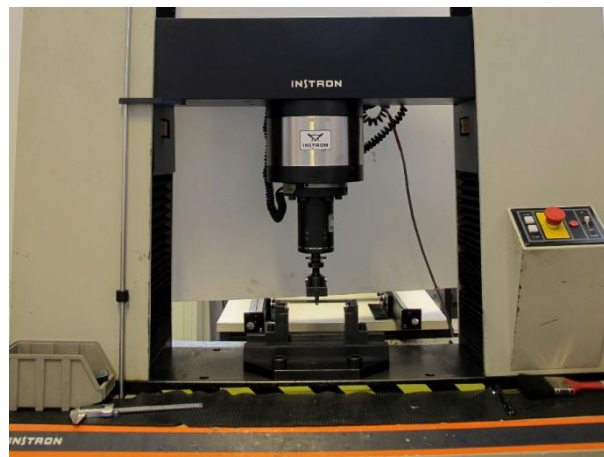
Figura 32 - Aspeto da montagem experimental para realização do ensaio SLB
