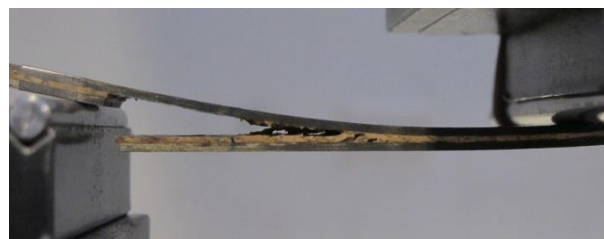
Figura 34 - Pormenor que mostra a dificuldade em identificar a frente de fenda (provete 20-6)
