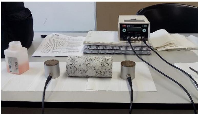
**Figura 53** – Aparelho de medição da velocidade de propagação de ultrassons.
