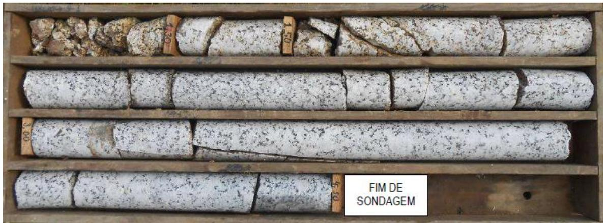
**Figura A.1** – Fotografia do testemunho da sondagem S1 (Caixa 1: 0,0 a 4,5 metros).
