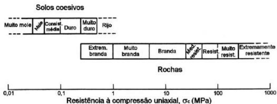
Figura 23 – Definição de solos coesivos e rochas de acordo com a classificação da ISRM, 1978 (adaptado de Hencher, 1993).
