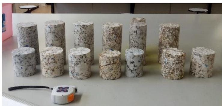
**Figura 29** – Provetes após a retificação.
