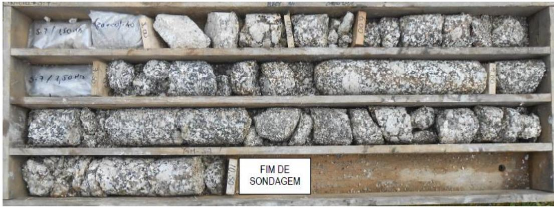
**Figura A.6** – Fotografia do testemunho da sondagem S7 (Caixa 1: 0,0 a 10,5 metros).
