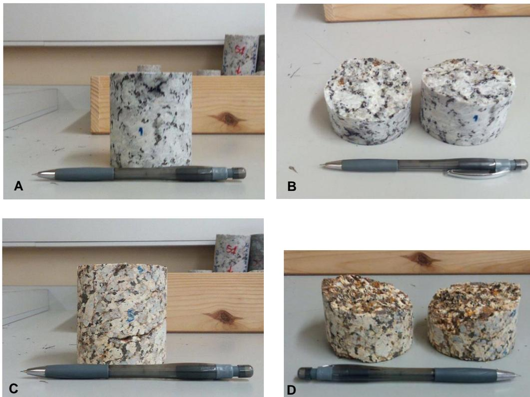
**Figura 79** – A e B: Provete 1b antes e após o ensaio, respetivamente; C e D: Provete 5b antes e após o ensaio, respetivamente.
