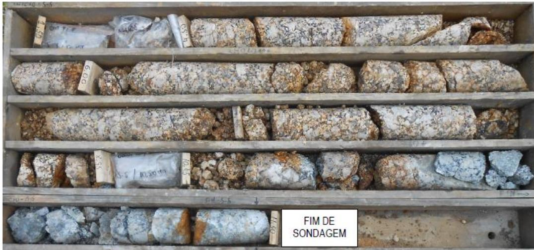
**Figura A.4** – Fotografia do testemunho da sondagem S5 (Caixa 1: 0,0 a 6,0 metros).
