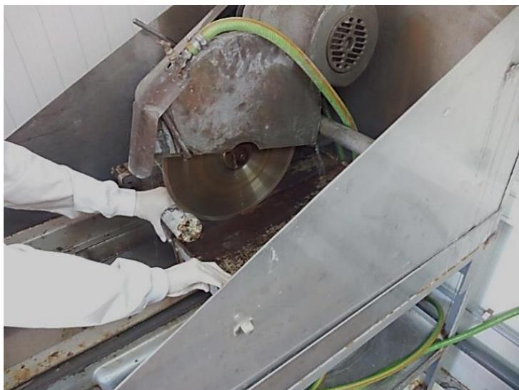
**Figura 27** – Procedimento do corte e retificação dos provetes seleccionados.
