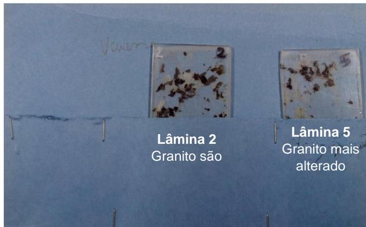
Figura 39 – Lâminas delgadas usadas para o estudo petrográfico do Granito de Guimarães.
