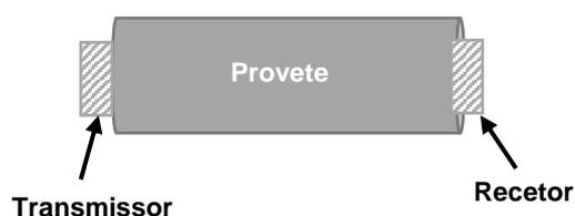
**Figura 54** – Posição do transmissor e recetor utilizado no ensaio de velocidade de propagação de ultrassons para os provetes do Granito de Guimarães (adaptado de ISRM, 1978).
