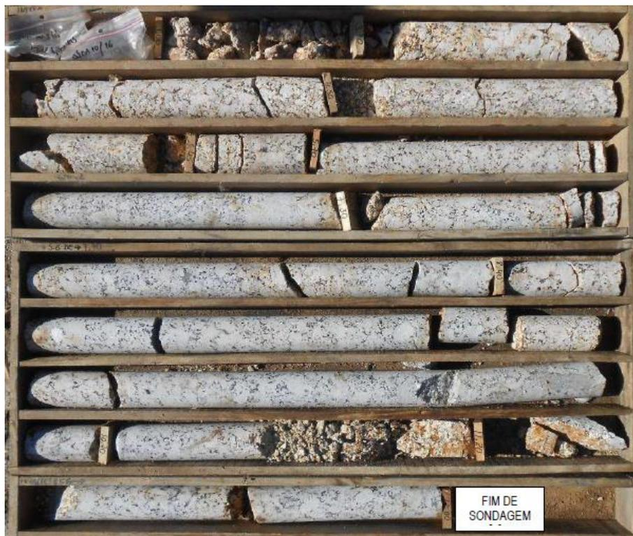
**Figura A.5** – Fotografia do testemunho da sondagem S6 (Caixa 1, 2 e 3: 0,0 a 12,0 metros).
