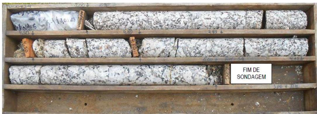
**Figura A.3** – Fotografia do testemunho da sondagem S4 (Caixa 1: 0,0 a 6,0 metros).
