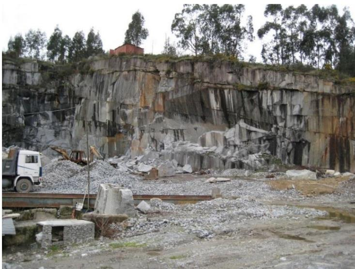
**Figura 36** – Maciço granitóide presente na Pedreira de Lajes onde se observa a atuação dos sulfuretos, originando o aspeto oxidado (superfície laranja) ao granito.
