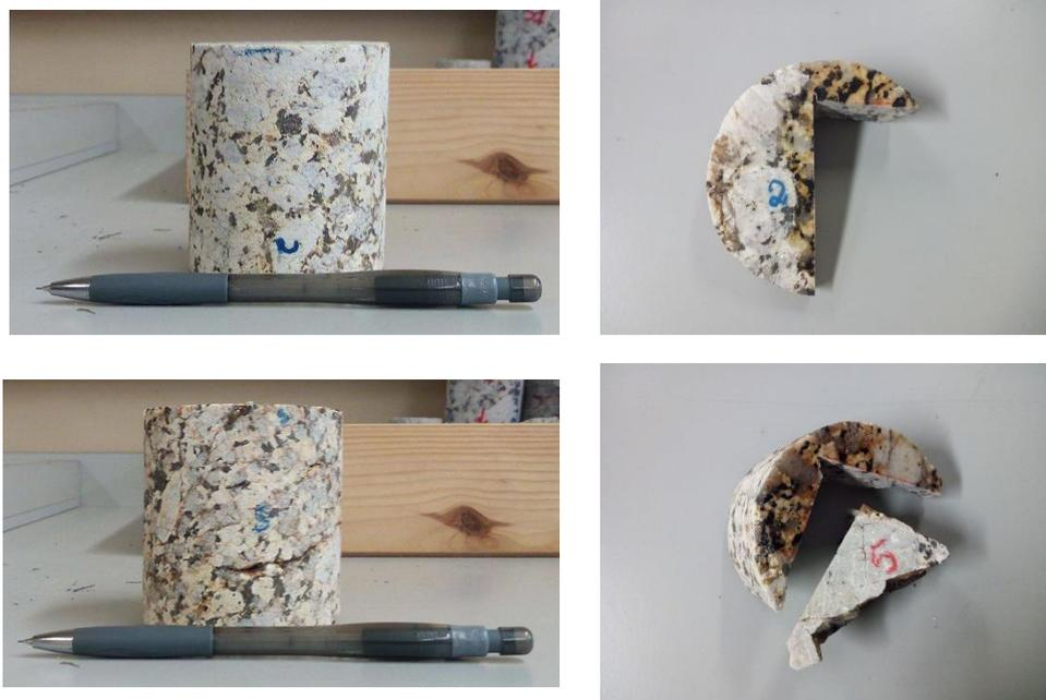
**Figura 38** – Provetes e topo dos provetes utilizados para produzir lâminas delgadas.
