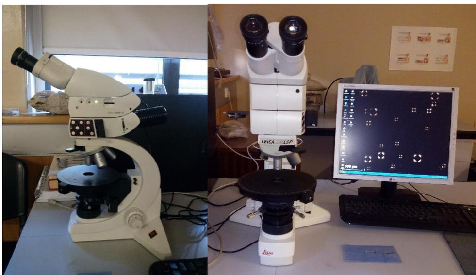
Figura 40 – Microscópio LEICA DMLSP acoplado ao computador utilizado para os estudos de petrografia realizados no DGAOT (FCUP).
