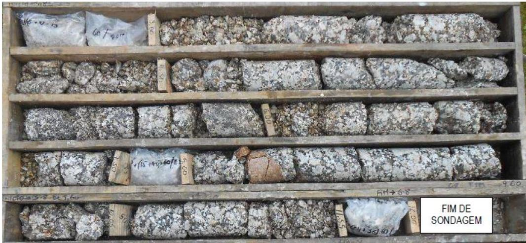
**Figura A.7** – Fotografia do testemunho da sondagem S8 (Caixa 1 e 2: 0,0 a 12,0 metros).
