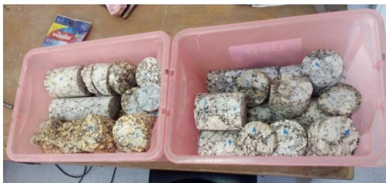
**Figura 28** – Provetes e topos dos provetes após o corte.
