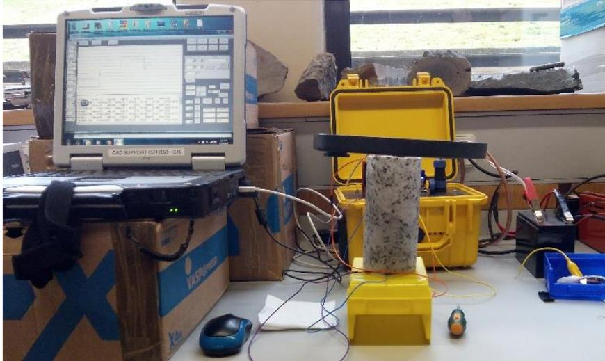
**Figura 46** – Medição da resistividade elétrica num provete do Granito de Guimarães.
