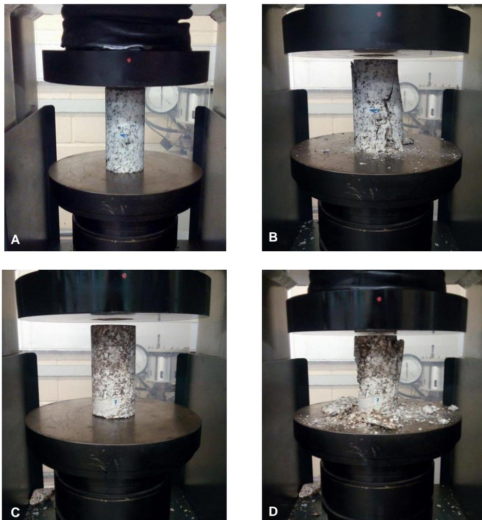
**Figura 78** – A e B: Provete 1a antes e após o ensaio, respetivamente; C e D: Provete 7a antes e após o ensaio, respetivamente.
