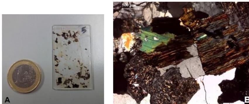
**Figura 64** – A: Lâmina delgada para o estudo petrográfico; B: Imagem em NX da lâmina 5.
