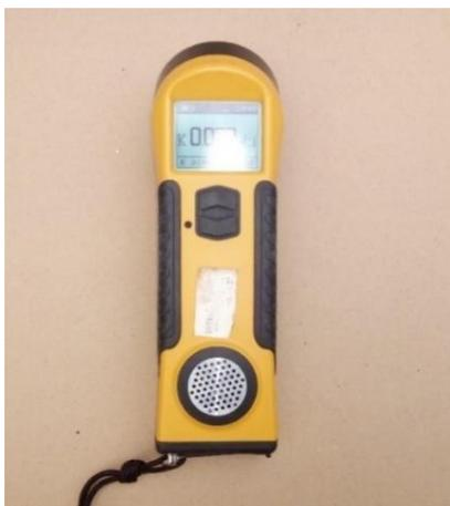
Figura 41 – Suscetibilímetro portátil (KT-10 *Terra Plus*).
