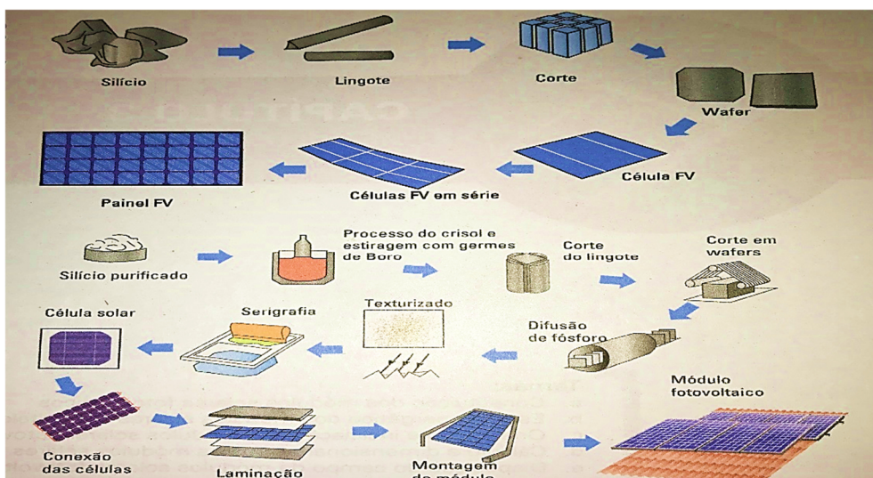
Figura 1 - Processo de fabrico de módulos fotovoltaicos
