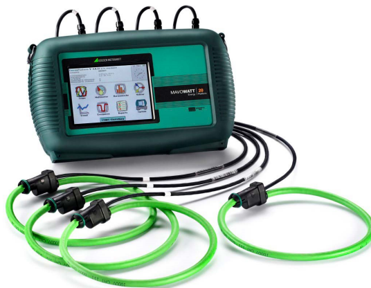
Figura 21 – Exemplo de um analisador de energia elétrica
