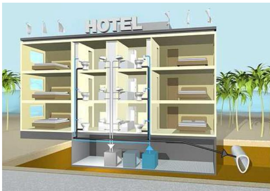
Figura 3.19 – Esquema de funcionamento de um sistema de aproveitamento de águas cinzentas num hotel [35].
