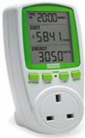
Figura 5.5 – Sistema de monitorização plug-in da Efergy [56].
