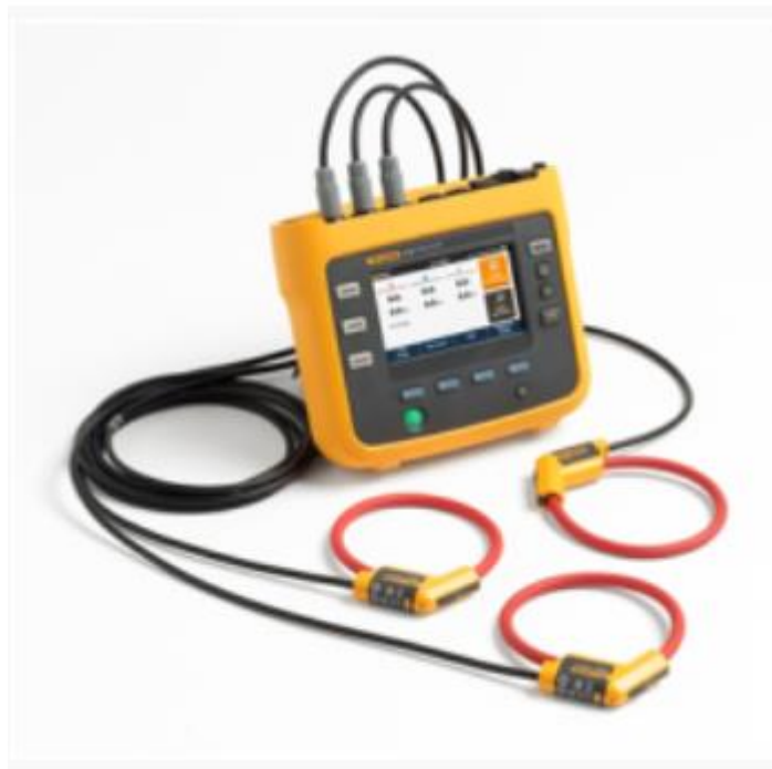
Figura 5.2 - Analisador de consumos Fluke 1730 [53].
