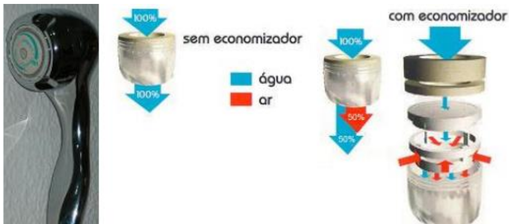
Figura 3.20 – Esquerda: Chuveiro com redução de caudal, Direita: Esquema de funcionamento de um economizador de água [36].
