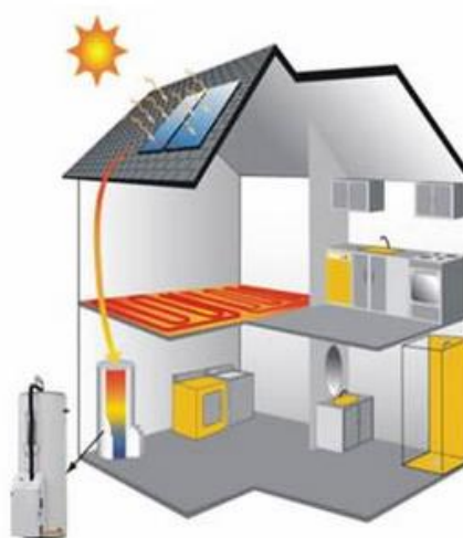
Figura 3.5 – Exemplo de sistema solar térmico para climatização [25].
