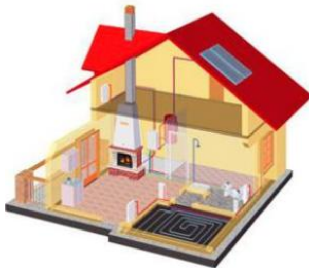
Figura 3.6 – Exemplo de um sistema misto (solar térmico + biomassa) [25].
