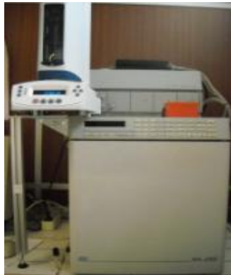
Figura A.4 – Cromatógrafo (Marca: DANI GC – DPC Digital Pressure Control), com injeção automática.
