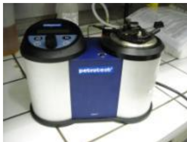
Figura A. 5 – Equipamento utilizado na determinação do ponto inflamação do óleo, Petrotest, modelo Rapid Tester S.3.
