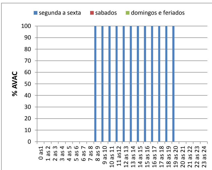
Gráfico 30 - Perfil de utilização do sistema de AVAC
