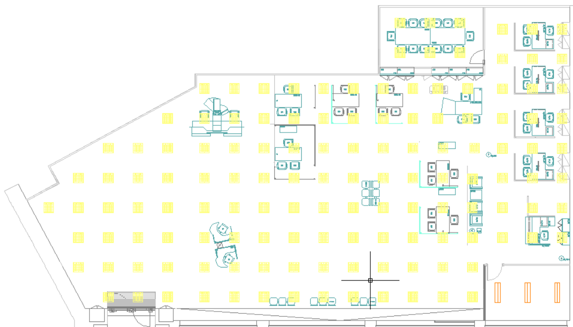
Figura 42 – Distribuição das luminárias
