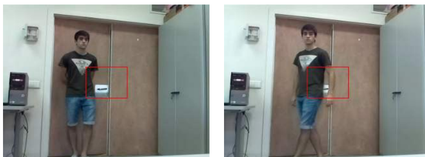
Figura 8: Objeto de seguimiento deformado al desplazarse.
