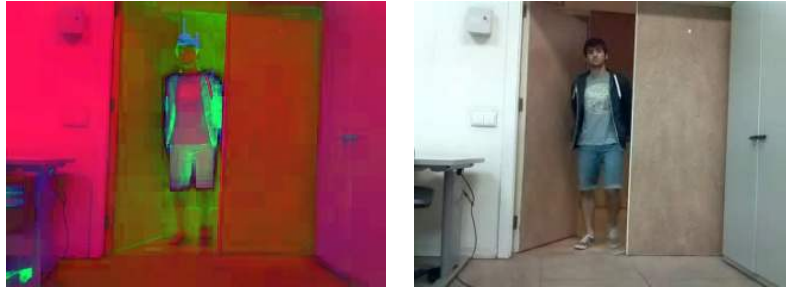
Figura 75: En la figura de la izquierda se muestra una imagen en el espacio de color HSV. En la figura de la derecha se muestra una imagen en el espacio de color RGB.
