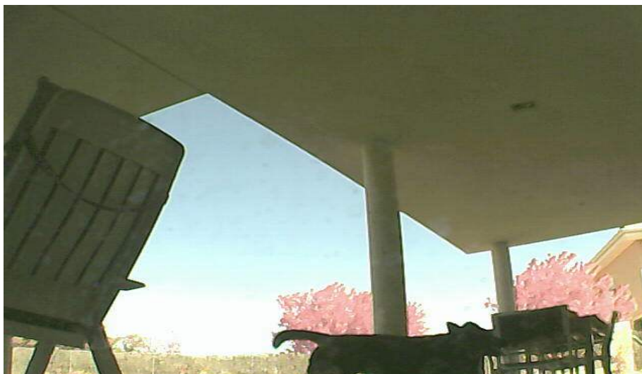
Figura 6: Falso positivo debido a la aparición de un perro en la secuencia obtenido con una cámara IP FI8918W del fabricante Foscam localizada en un jardín.
