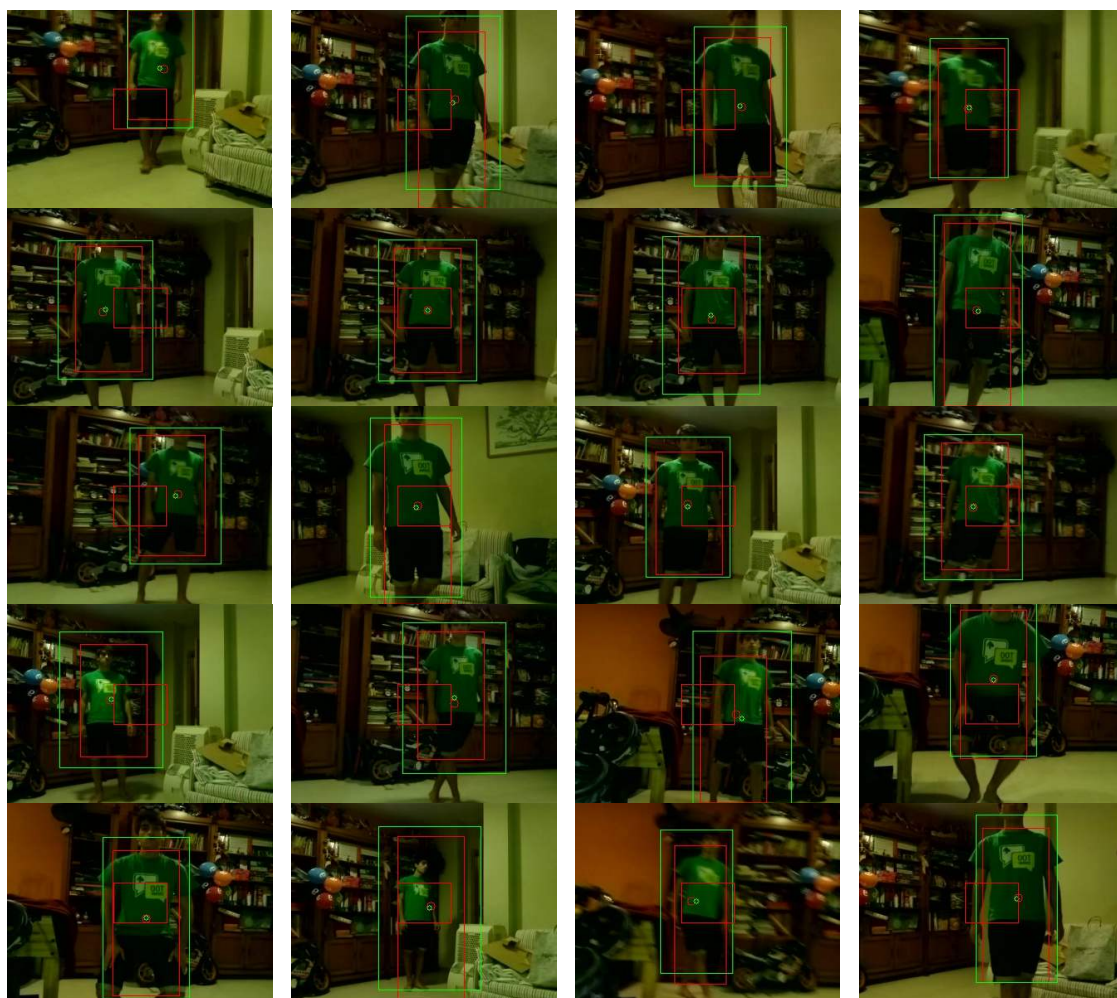
Figura 96: Resultados del seguimiento de una persona por un entorno con una intensidad de luz media. El rectángulo verde viene dado por CAMShift. El rectángulo rojo grande viene dado por la región donde aparece el backprojection. El rectángulo rojo central representa el centro de la imagen. El círculo verde representa el estado del filtro de Kalman. El círculo rojo representa la predicción del filtro de Kalman.
