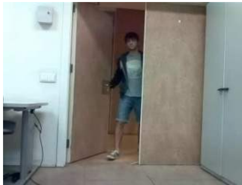
Figura 60: Cuando un usuario abre la puerta del entorno de vigilancia se genera un cambio lumínico brusco.
