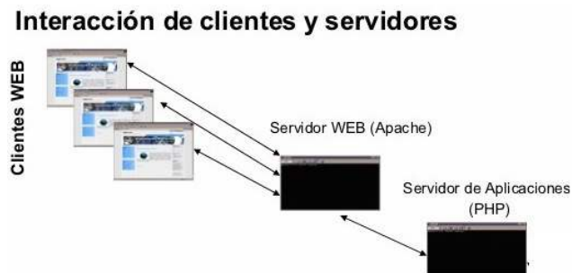
Figura 45: Interacción de clientes y servidor a través de Apache.
