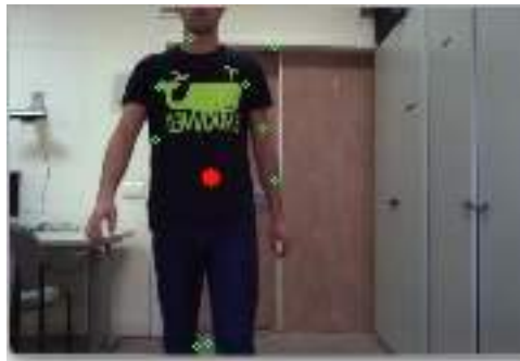
Figura 15: Ejemplo del detector de esquinas desarrollado por Harris.
