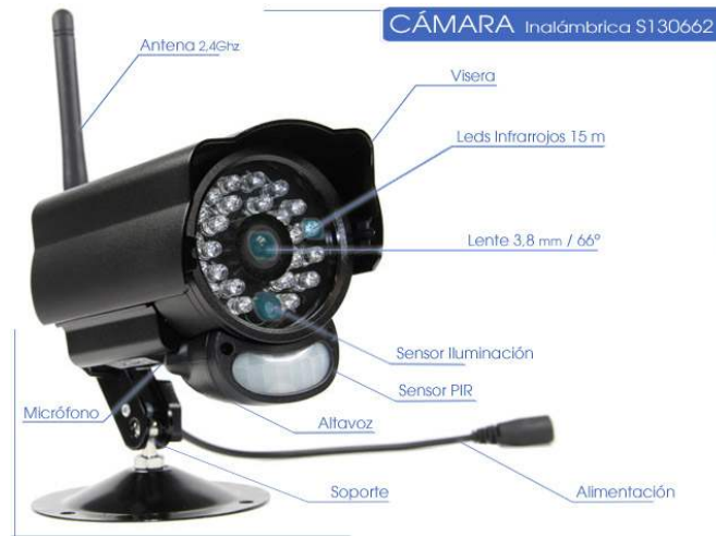
Figura 4: Elementos de una cámara IP comercial.
