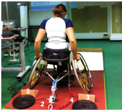
Figura 3 – Posizione cella di carico (1), ancoraggio carrozzina (2), blocchi di sicurezza (3) e catena di sicurezza (4).
