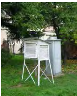
Figura 2.17 – A sinistra: stazione meteorologica ex-SIMN di Bra: capannina meteorologica per le misure termometriche e pluviometro (foto: A. Albanese).
