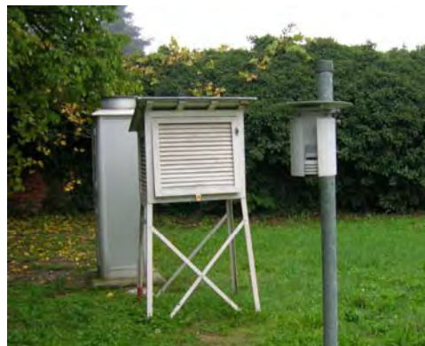
Figura 2.17 – A sinistra: stazione meteorologica ex-SIMN di Bra: capannina meteorologica per le misure termometriche e pluviometro (foto: A. Albanese).
