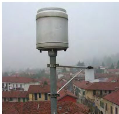
Figura 2.17 – A sinistra: stazione meteorologica ex-SIMN di Bra: capannina meteorologica per le misure termometriche e pluviometro (foto: A. Albanese).
