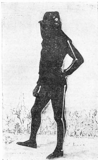
Fig. 5. UOMO VESTITO DI NERO E PORTANTE LINEE E PUNTI LUMINOSI PER LO STUDIO CRONOFOTOGRAFICO DEL MOVIMENTO.
