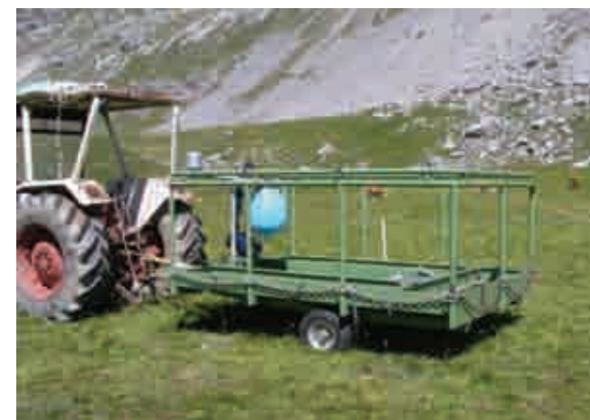
Figura 16. Mungitrici su carro mobile per seguire lo spostamento delle mandrie da latte
