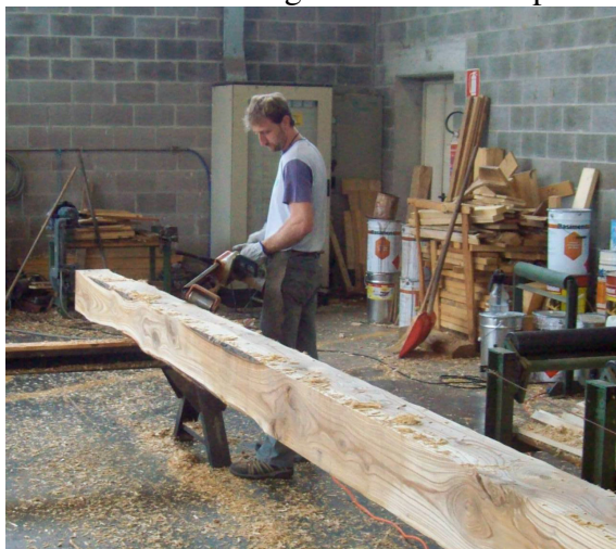
Figura 2. Travi di castagno "Uso Fiume". Gli assortimenti vengono squadrati e successivamente piallati a mano con smusso fino alla punta, mantenendo una sezione costante. A sinistra, lavorazione effettuata con pialla a mano di travi in castagno "Uso Fiume" e, a destra, particolare di alcune sezioni con smusso.
