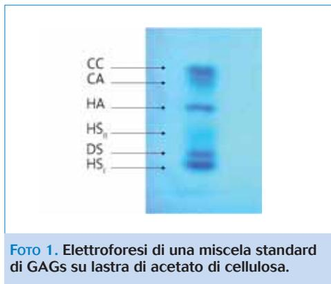
Foto 1. Elettroforesi di una miscela standard di GAGs su lastra di acetato di cellulosa.
