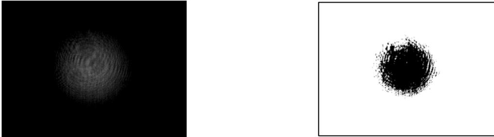
Figura 30: a sinistra: spot acquisito dalla camera Epix in corrispondenza della posizione centrale (N°5), con un framerate di 25 FPS e con un tempo di esposizione di 1.5 ms; a destra: immagine binaria dello stesso spot
