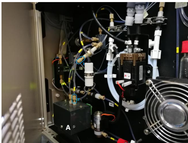
Figura 17 - Vista lateral direita do analisador: A - célula eletroquímica (CE); 1 - tubo 1; 2 - tubo 2.
